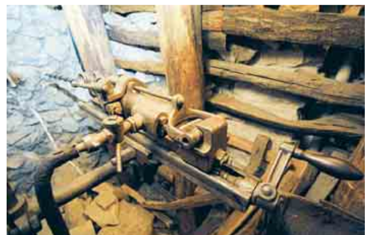
Maschinen wie dieser Druckluft-Bohrer im Bensberger Museum galten als Meilensteine der Bergbautechnik.
